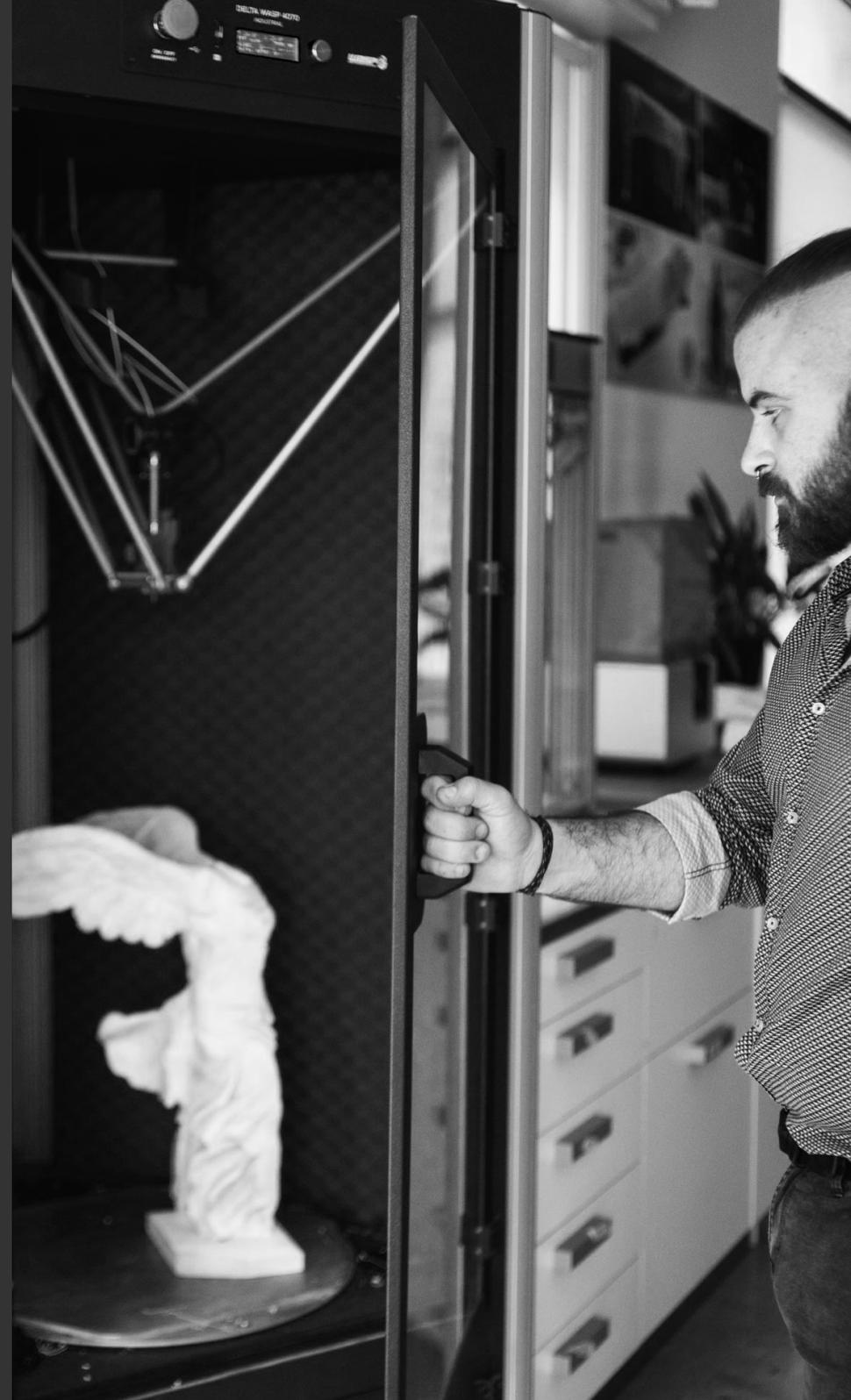
La stampa 3D può essere utilizzata anche come produzione del pezzo cosiddetto "Positivo" per la successiva creazione di uno stampo, che permetterà successivamente di realizzare lo stesso modello nel materiale necessitato, tecnica molto utilizzata nel settore artistico (fig. 14).
